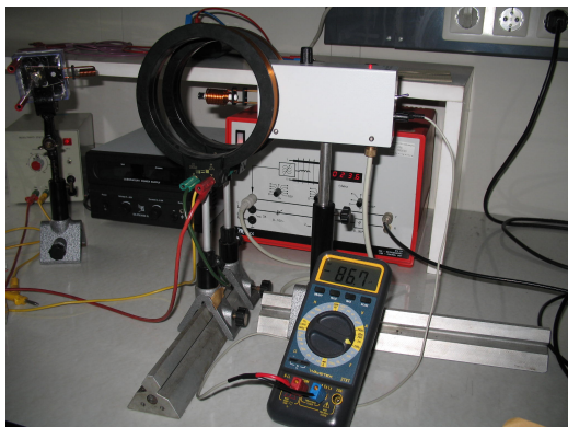
Abb.3: Aufbau mit Helmholtzspulen
